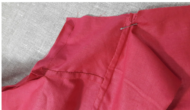
Рис. 11. Соединение срезов рукавов с ластовицей
