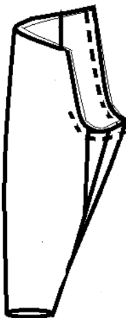
Рис. 19. Обработка среднего шва портов
